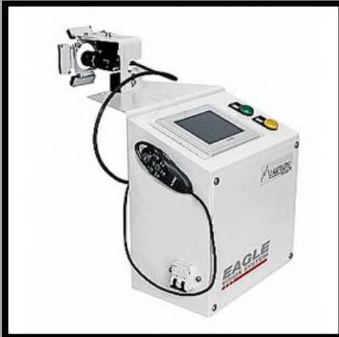
Sistema di visione estremamente potente per il riconoscimento di oggetti e la loro marcatura in fase. Dispone di una illuminazione a diodi luminosi, regolabile, particolarmente efficace ed adatta a tutti gli oggetti.
